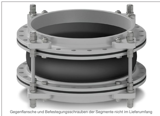
Dodatočne montovateľné obmedzovače axiálneho pohybu typu LSS s guľovými podložkami, uchytenie na protipríruby - obmedzenie axiálneho pohybu, laterálny pohyb možný
