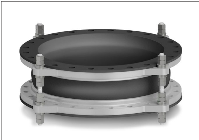
Obmedzovače axiálneho pohybu typu ZSS s guľovými podložkami - obmedzenie axiálneho pohybu, laterálny pohyb možný
