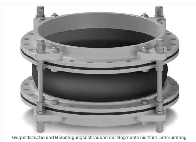
Dodatočne montovateľné obmedzovače axiálneho pohybu typu LSS s guľovými podložkami, uchytenie na protipríruby - obmedzenie axiálneho pohybu, laterálny pohyb možný
